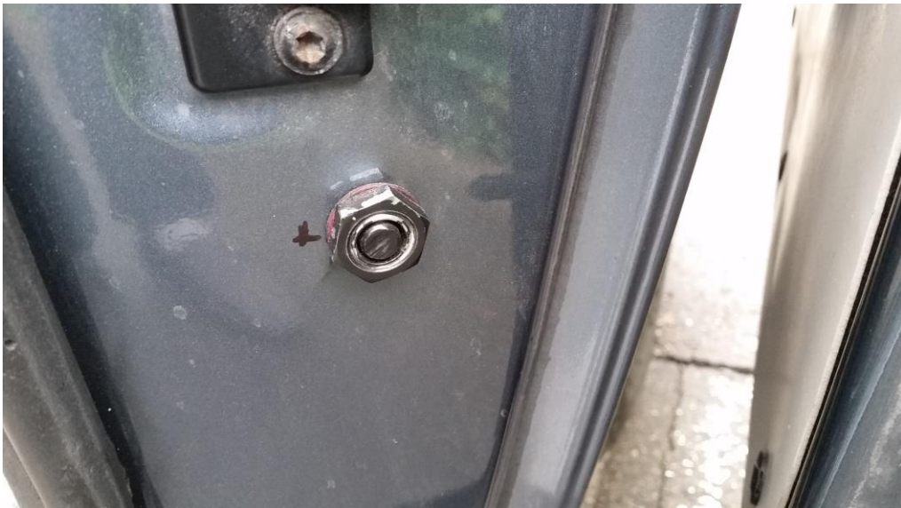
Holm Schiebetür HL, Bolzen eingefahren. Von vorn fotografiert.
