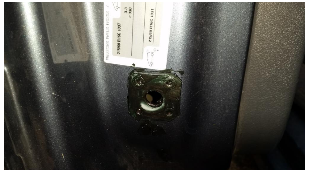
Das Gegenstück in der Tür VL. Das Kunststoffteil ist ca 40x40x4mm, mit 5mm Edelstahlschrauben, 5mm Edelstahlgewindenieten verschraubt. Weil hier der Abstand zum Holm gering ist, musste das Blech auch durchgebohrt werden. Lackiert mit Spezialrostschutz. Das ganze liegt außerhalb der Türdichtung und Innenfolie.
