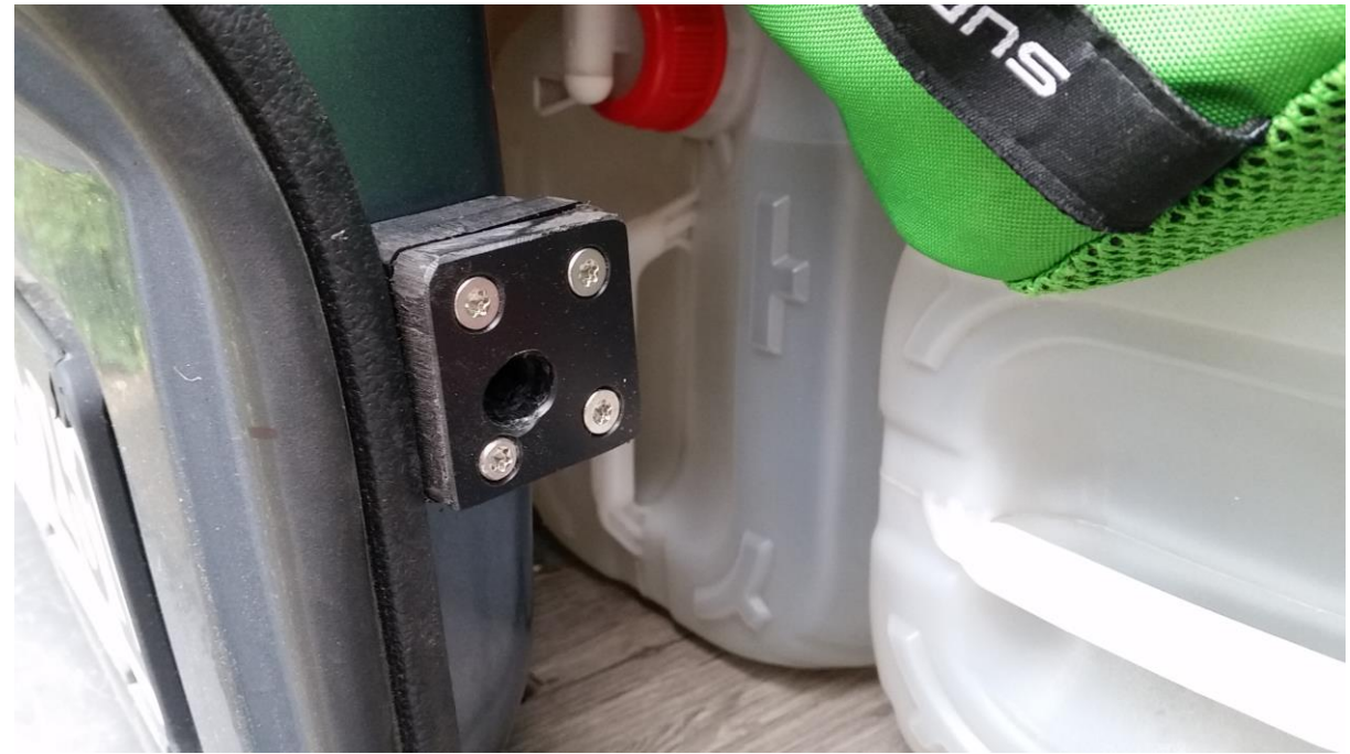
Das Gegenstück an der Hecktür HL. Hier ist der Abstand über 40mm, darum sind 3 Platten verbaut. Die Wandung ist leicht schräg, zum Ausgleich liegen zwischen den Platten vorne je 2 Unterlagscheiben und die Neigung zum Bolzen ist nicht zu extrem.
