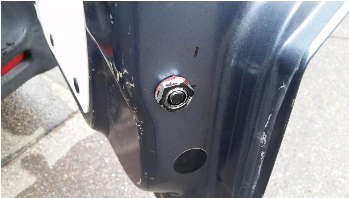
Hecktür HR. Dieses FZG hat Flügeltüren im Heck. Der Bolzen ist in der rechten Tür eingebaut. Das Kabel ist in der vorhandenen Gummiführung verlegt.
