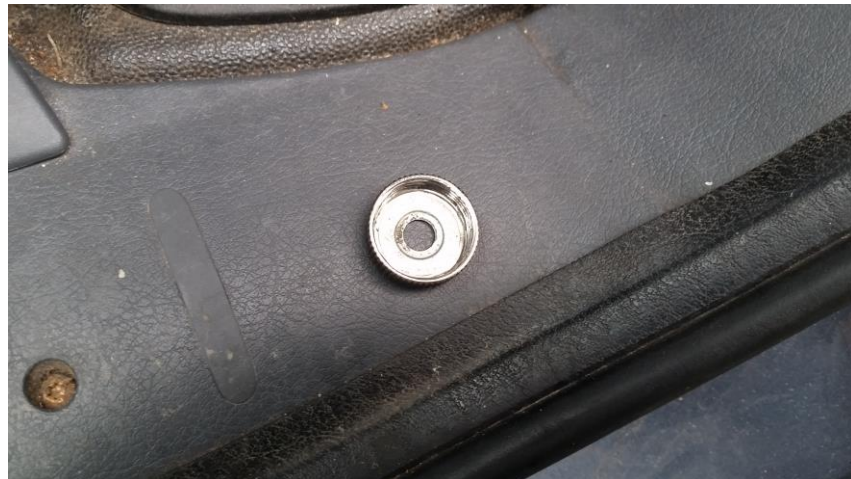
Die Abdeckung ist aus dem Sanitärbereich, aus Kunststoff mit eingeklebter 8mm Scheibe und passt mit leichter Klemmung exakt auf die M16-Mutter. So kann der Bolzen während der Fahrt nicht verriegeln (Auffahrunfall oder ähnliches).
