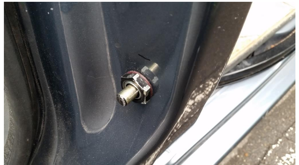
Holm VL ausgefahren, ca 15mm. Die Dichtung ist aus dem Sanitärbereich.
