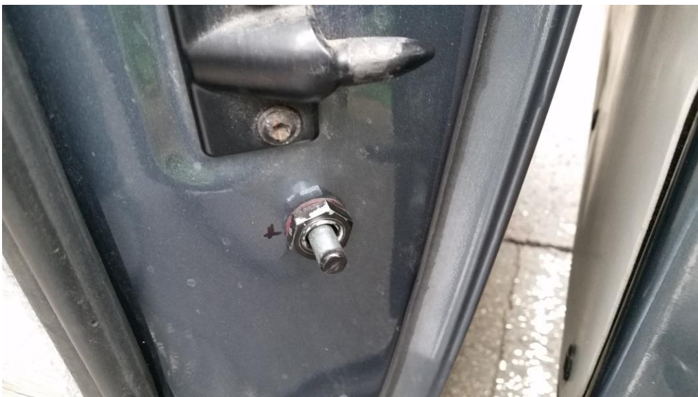
Holm Schiebetür HL, Bolzen ausgefahren
