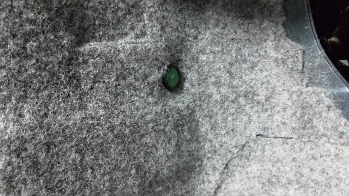
Taster zur Fernbedienung im Holm hinten links und rechts. Bohrloch 20mm.
