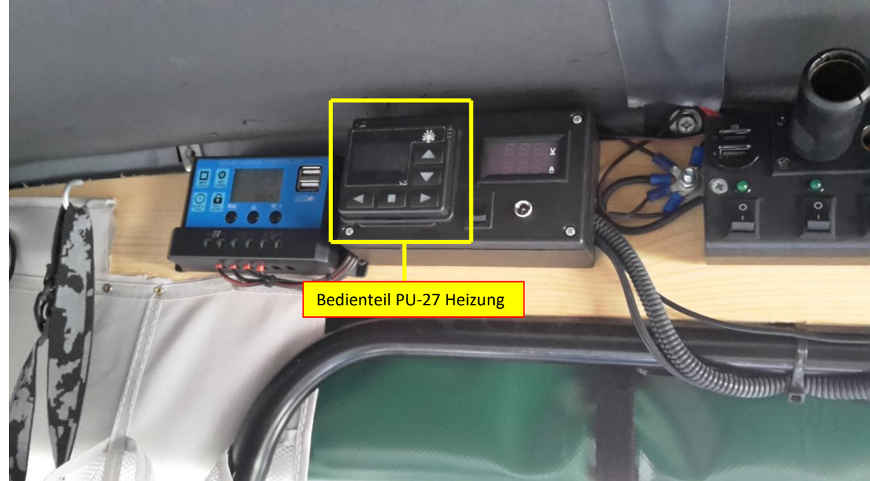
Bedienteil PU-27 Standheizung im Laderaum (Wohnraum). Unter dem Dach, an der Trennwand zur Fahrerkabine. Es gibt auch die preiswertere Version mit Drehknopf ohne Display. Aber diese zeigt aktuelle Zustände an und kann Zeiten voreinstellen.
