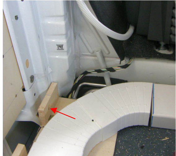
Lüftungskanal und Leerrohre unter dem Küchenblock im Bereich des Gaskasten sowie dessen, seit 2015 zulässigen, kleinen Entlüftung durch die Seitenwand bei max. einer 5 kg Gasflasche.
