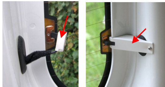
Die bruchempfindlichen originalen Anschlüsse (links) für die Heckscheibenheizung, jetzt mit Eigenbau „knibbel- und kindersicher“ abgedeckt (rechts). Die unschönen Blech-Fensterrahmen werden noch verkleidet.
