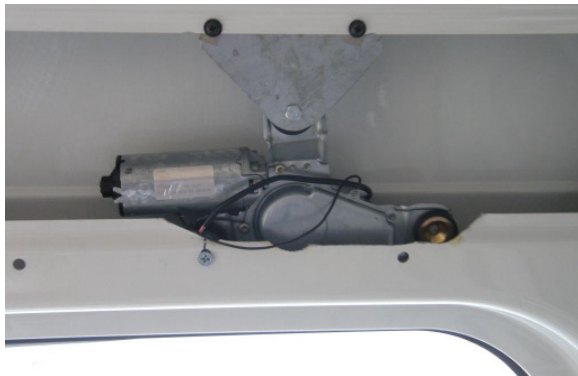
Einbau der Heckwisch-/Waschanlage in der Hecktür sowie umlaufend Leerrohre und Kabel für die weiteren (vermuteten) elektrischen Anforderungen.
