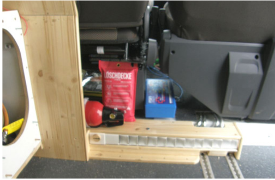
„Trittfest“ verkleideter Heizkanal am Boden für die Fondpassagiere, Platz für Feuerlöscher & -Decke und Verbandskasten.
