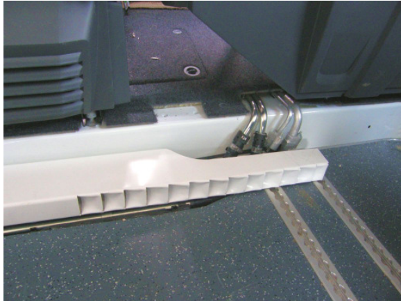
Selbstgebauter Auslass der „Bodenheizung“ für die hinteren Sitze aus einem PVC-Lüftungskanal.
