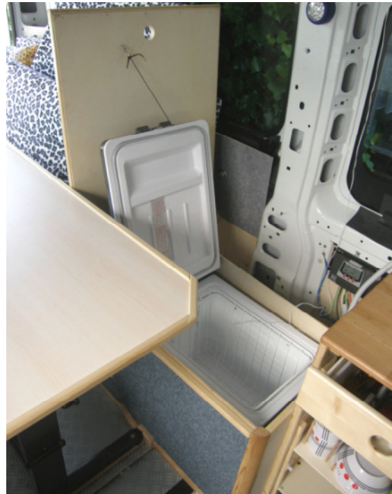
Neben dem Küchenblock der sichere und platzsparende Einbau der Kühlbox im Staukasten mit „Automatik-Deckel“ im Staukasten, da der Zugang „nur“ zu den Mahlzeiten nötig schien. So konnte auf eine stabile Auszugstechnik zugunsten Stauraum im Küchenblock verzichtet werden. Trotz Kompressortechnik beim Schlafen kaum zu hören. Darunter stabil am Boden verschraubt eine Zusatzbatterie (Platz für weitere zwei) und „Technik“.
