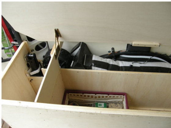
Was soll das denn? Original kommt vom hinteren Gebläse warme Luft nur am Boden, kalte nur an der Decke. Eine Mischung dazwischen geht nicht! Also Umbau mit nun gemeinsamem Gebläseausgang! Warm- und Kaltmischung ist jetzt beliebig möglich. Schaltbilder der Bordelektrik gibt es auch nicht bzw. sind falsch, also alle Leitungen „irgendwie“ ausmessen.
